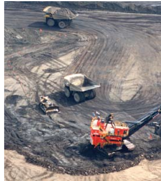
Le enormi macchine usate per scavare e trasportare le sabbie catramose in Alberta fanno sembrare minuscolo un bulldozer comune.
